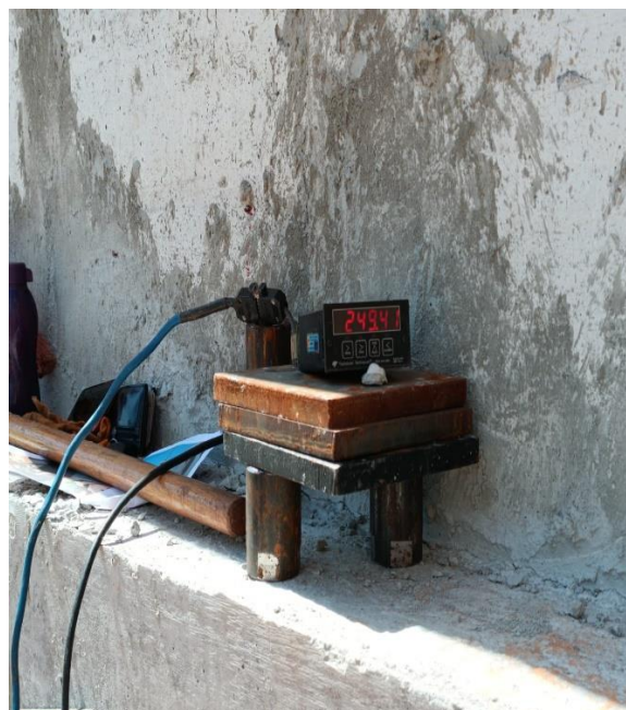
Figuras 4 e 5: Ensaio de protensão dos tirantes.
